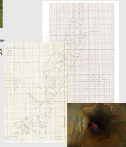
Figura 8: Croquis de campo e foto mostrando conduto no interior da caverna BP400.
